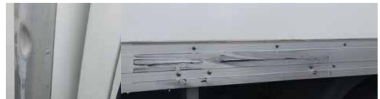
Perfiles laterales de los bajos de la carrocería: Deformaciones que merecen la pena de reparar
