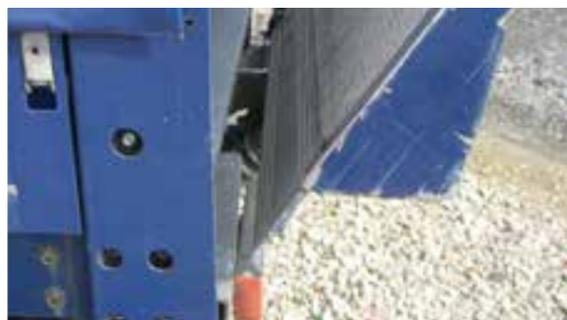
Compuerta de carga: Deformaciones de la plataforma que merece la pena de reparar
