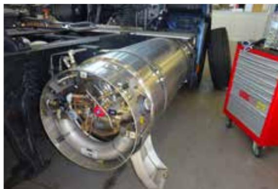
**Nota importante:** El plan de mantenimiento contempla la sustitución obligatoria de las válvulas limitadoras primaria y secundaria de los depósitos de GNL antes del quinto año de su fabricación; en caso de que el vehículo se devuelva al cabo de 5 años o más a partir de la fecha de la firma del contrato, el cliente deberá cerciorarse de que se hayan sustituido las válvulas limitadoras primaria y secundaria antes de devolver el vehículo a Iveco.
