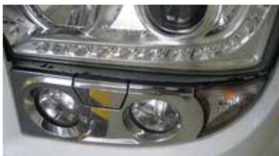
Arañazos en el campo de iluminación, grietas, condensación, puntos de fijación rotos
