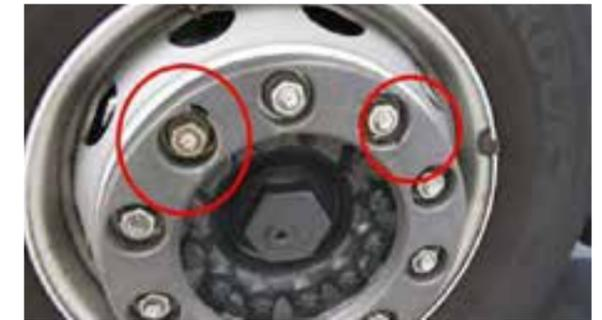
🔄 Tapacubos: Deformado, roto, falta material o está arrancado
