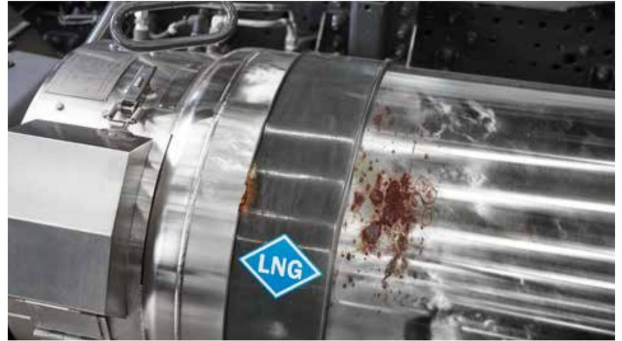
Oxidación, abolladuras, roturas y/o hendiduras → cobro por sustitución de los soportes y los aros.
