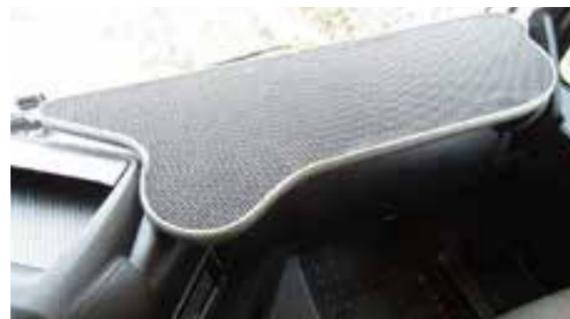
☑️ Revestimiento de la pared interior rasgado detrás del asiento del conductor
