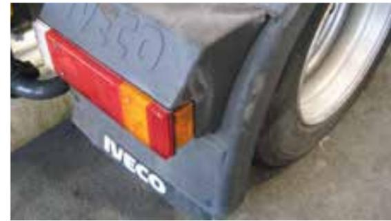
Marcas profundas y deformación
