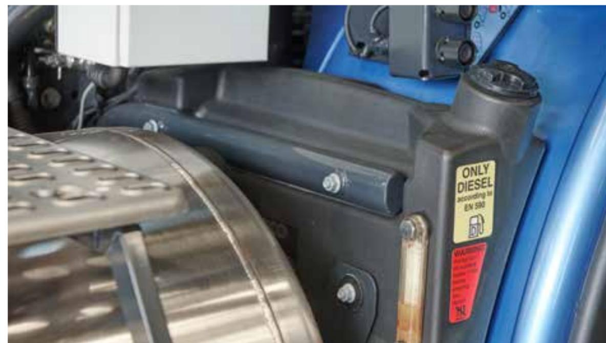
Falta la llave del depósito del calefactor adicional → cobro por sustitución de la llave.
