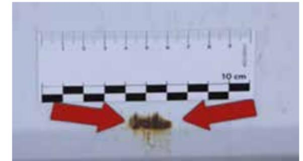
Arañazos con oxidación, depósitos químicos o de otro tipo que no se pueden limpiar
