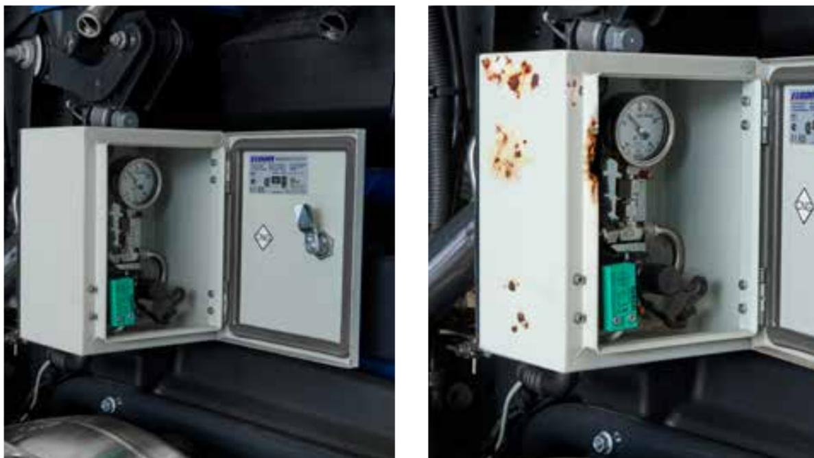
Óxido en el cárter de protección del receptáculo de llenado → sin cargo por daños.
