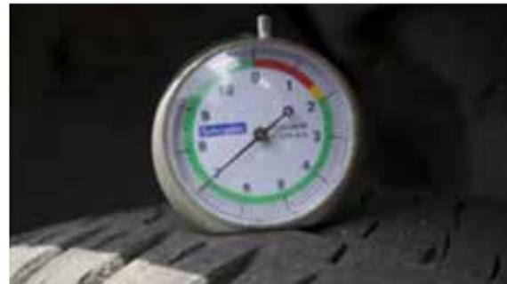
Neumáticos: Base de profundidad de la ranura  $\geq$  7 mm (CONFORME)
