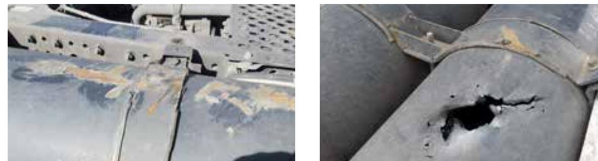
Constancia de reparaciones en la bombona de GNC → cobro por sustitución de la bombona de GNC.
