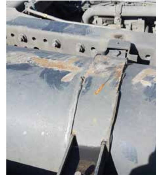
Oxidación, abolladuras, roturas y/o hendiduras → cobro por sustitución de los soportes y los aros.
